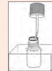
Der Einsatz sorgt dafür, dass überschüssige Flüssigkeit abgestreift wird.
